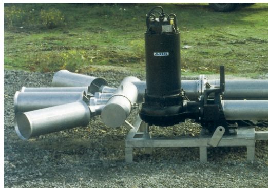
Hình 1: Kỹ thuật cấp oxy tinh khiết được Messer phát triển: Ống phân phối khí (bên trái), đầu phun (giữa), hệ thống cấp oxy (bên phải).
