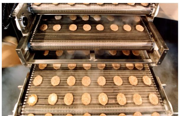
Hệ thống Cấp đông nhanh còn có giá mua tương đối thấp, rất linh hoạt, có thể dễ dàng mở rộng mà vẫn có kích thước nhỏ hơn nhiều so với hệ thống làm lạnh cơ học với dung lượng tương đương. Hệ thống không yêu cầu xây dựng dân dụng đặc biệt (ví dụ như phòng máy với công suất điện cao). Máy Cấp đông nhanh không phải lắp đặt cố định và dễ dàng để vận chuyển. Bồn CO<sub>2</sub> và N<sub>2</sub> được đặt ở ngoài trời.
